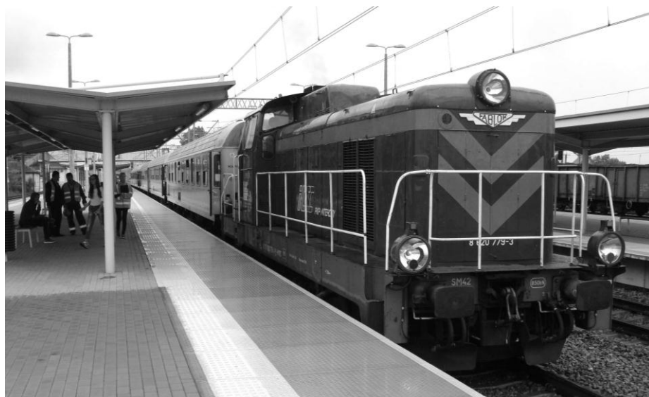
• Objazd linii Warszawa – Lublin. Pociąg TLK „Staszic” relacji Bydgoszcz – Zagórz przed odjazdem ze stacji Łuków. Na czele pociągu lokomotywa SM42, która nie jest w stanie osiągnąć prędkości koniecznej do jazdy zgodnej z rozkładem jazdy.
